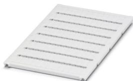
Repères pour blocs de jonction, Planche, blanc, vierge, repérable avec : BLUEMARK ID COLOR, BLUEMARK ID, BLUEMARK CLED, PLOTMARK, CMS-P1-PLOTTER, type de montage: encliquetage dans la rainure de repérage élevée, pour bloc de jonction au pas de : 5,2 mm, surface utile: 10,5 x 4,6 mm, Nombre d'étiquettes: 96
