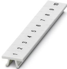
Repérage ZB, Rubans, blanc, repéré, repérable avec : CMS-P1-PLOTTER, impression longitudinale: numérotation continue 1 ... 10, 11 ... 20, etc. jusqu'à 491 ... 500, type de montage: encliquetage dans la rainure de repérage élevée, pour bloc de jonction au pas de : 6,2 mm, surface utile: 6,15 x 10,5 mm, Nombre d'étiquettes: 10
