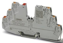
Disjoncteur d'appareil électronique monocanal, avec limitation de courant active pour la protection de quatre consommateurs à 24 V DC en cas de surcharge et de court-circuit. Répartition facile du potentiel avec les composants du système de blocs de jonction CLIPLINE complete. Avec intensité nominale fixe. Pour une installation sur des rails DIN.
