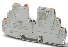
Disjoncteur d'appareil électronique monocanal, avec limitation de courant active pour la protection de quatre consommateurs à 24 V DC en cas de surcharge et de court-circuit. Répartition facile du potentiel avec les composants du système de blocs de jonction CLIPLINE complète. Avec dispositif de verrouillage électronique des intensités nominales réglées. Pour une installation sur des rails DIN.
