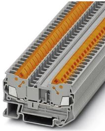
Blocs de jonction simple, tension nominale: 800 V, intensité nominale: 24 A, type de raccordement: Raccordement rapide, 1er étage, Section de référence: 2,5 mm<sup>2</sup>, section : 0,5 mm<sup>2</sup> - 2,5 mm<sup>2</sup>, type de montage: NS 35/7,5, NS 35/15, coloris: gris
