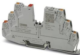
Disjoncteur d'appareil électronique monocanal, avec limitation de courant active pour la protection de quatre consommateurs à 24 V DC en cas de surcharge et de court-circuit. Répartition facile du potentiel avec les composants du système de blocs de jonction CLIPLINE complete. Avec intensité nominale fixe. Pour une installation sur des rails DIN.
