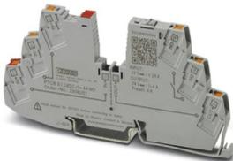
Disjoncteur d'appareil électronique monocanal, avec limitation de courant active pour la protection de quatre consommateurs à 24 V DC en cas de surcharge et de court-circuit. Répartition facile du potentiel avec les composants du système de blocs de jonction CLIPLINE complete. Avec dispositif de verrouillage électronique des intensités nominales réglées. Pour une installation sur des rails DIN.
