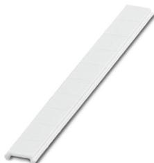
Repérage ZB, plat, Rubans, à commander : par bandes, blanc, impression selon les indications du client, type de montage: encliquetage dans la rainure de repérage plate, pour bloc de jonction au pas de : 6,2 mm, surface utile: 5,15 x 6,15 mm, Nombre d'étiquettes: 10
