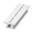
Ruban de repérage ZB, Rubans, blanc, repéré, impression transversale: numérotation continue 1 ... 10, 11 ... 20, etc. jusqu'à 91 ... 100, type de montage: encliquetage, pour bloc de jonction au pas de : 3,5 mm, surface utile:  $3.5 \times 10.5$  mm, Nombre d'étiquettes: 10
