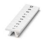
Ruban de repérage ZB, Rubans, blanc, repéré, impression longitudinale: numérotation continue 1 ... 10, 11 ... 20, etc. jusqu'à 91 ... 100, type de montage: encliquetage, pour bloc de jonction au pas de : 3,5 mm, surface utile: 3,5 x 10,5 mm, Nombre d'étiquettes: 10
