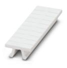
Ruban de repérage ZB, à commander : par bandes, blanc, impression selon les indications du client, type de montage: encliquetage dans la rainure de repérage élevée, pour bloc de jonction au pas de : 3,5 mm, surface utile: 3,5 x 10,5 mm, Nombre d'étiquettes: 10
