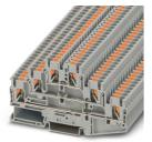
Bloc de jonction à plusieurs étages, tension nominale: 500 V, intensité nominale: 20 A, type de raccordement: Raccordement Push-in, 1., 2. und 3. Etage, Section de référence: 2,5 mm $^2$ , section : 0,14 mm $^2$  - 4 mm $^2$ , type de montage: NS 35/7,5, NS 35/15, coloris: gris
