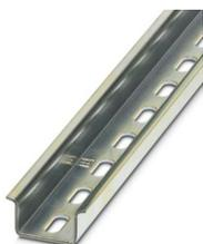
Profilé percé, Conditionnement par 25 unités (50 m), similaire à EN 60715, matériau: Acier, galvanisé, traité par passivation couche épaisse, Profil standard, coloris: argenté
