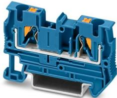
Blocs de jonction simple, tension nominale: 800 V, intensité nominale: 32 A, nombre de connexions: 2, type de raccordement: Raccordement Push-in, Section de référence: 4 mm<sup>2</sup>, section : 0,2 mm<sup>2</sup> - 6 mm<sup>2</sup>, type de montage: NS 35/7,5, NS 35/15, coloris: bleu
