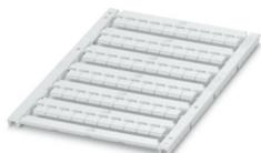
Repères pour blocs de jonction, à commander : sous forme de planche, blanc, impression selon les indications du client, type de montage: encliquetage dans la rainure de repérage plate, pour bloc de jonction au pas de : 6,2 mm, surface utile: 5,4 x 4,7 mm, Nombre d'étiquettes: 60
