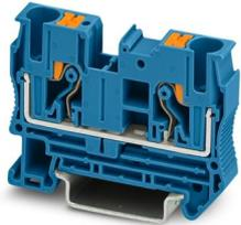
Blocs de jonction simple, tension nominale: 1000 V, intensité nominale: 41 A, nombre de connexions: 2, nombre de pôles: 1, type de raccordement: Raccordement Push-in, Section de référence: 6 mm<sup>2</sup>, section : 0,5 mm<sup>2</sup> - 10 mm<sup>2</sup>, type de montage: NS 35/7,5, NS 35/15, coloris: bleu
