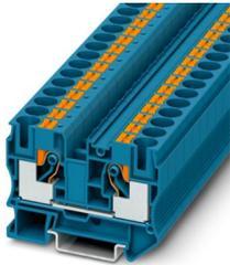
Blocs de jonction simple, tension nominale: 1000 V, intensité nominale: 57 A, nombre de connexions: 2, type de raccordement: Raccordement Push-in, Section de référence: 10 mm<sup>2</sup>, section : 0,5 mm<sup>2</sup> - 16 mm<sup>2</sup>, type de montage: NS 35/7,5, NS 35/15, coloris: bleu
