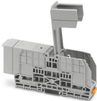
Bloc de jonction à boulon, tension nominale: 1500 V, intensité nominale: 192 A, nombre de connexions: 2, nombre de pôles: 1, type de raccordement: Raccordement boulonné, 1er étage, Section de référence: 70 mm<sup>2</sup>, type de montage: NS 35/7,5, NS 35/15, vissage direct, coloris: gris
