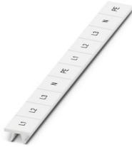
Repères pour blocs de jonction, Rubans, blanc, repéré, repérable avec : CMS-P1-PLOTTER, longitudinal: L1, L2, L3, N, PE, L1, L2, L3, N, PE, type de montage: encliquetage, pour bloc de jonction au pas de : 10,2 mm, surface utile: 10,15 x 10,5 mm, Nombre d'étiquettes: 10
