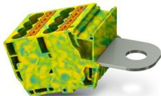
Bloc de jonction de dérivation, tension nominale: 1000 V, intensité nominale: 41 A, nombre de connexions: 9, type de raccordement: Raccordement Push-in, 1er étage, Section de référence: 6 mm<sup>2</sup>, section : 0,5 mm<sup>2</sup> - 10 mm<sup>2</sup>, Raccordement boulonné, 1er étage, type de montage: sur embase, coloris: vert/jaune
