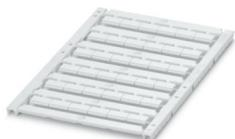
Repères pour blocs de jonction, à commander : sous forme de planche, blanc, impression selon les indications du client, type de montage: encliquetage dans la rainure de repérage plate, pour bloc de jonction au pas de : 10,2 mm, surface utile: 9,4 x 4,7 mm, Nombre d'étiquettes: 36
