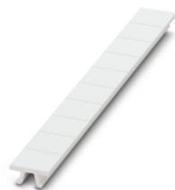
Ruban de repérage ZB, à commander : par bandes, blanc, impression selon les indications du client, type de montage: encliquetage dans la rainure de repérage élevée, pour bloc de jonction au pas de : 10,2 mm, surface utile: 10,15 x 10,5 mm, Nombre d'étiquettes: 10
