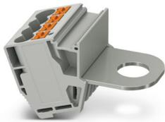
Bloc de jonction de dérivation, tension nominale: 1000 V, intensité nominale: 41 A, nombre de connexions: 5, type de raccordement: Raccordement Push-in, 1er étage, Section de référence: 6 mm<sup>2</sup>, section : 0,5 mm<sup>2</sup> - 10 mm<sup>2</sup>, Raccordement boulonné, 1er étage, type de montage: sur embase, coloris: gris
