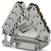
Distributeurs de potentiel, tension nominale: 250 V, intensité nominale: 17,5 A, type de raccordement: Raccordement Push-in, 1., 2., 3. und 4. Etage, Section de référence: 1,5 mm<sup>2</sup>, section : 0,14 mm<sup>2</sup> - 2,5 mm<sup>2</sup>, montage: NS 35/7,5, NS 35/15, coloris: gris, couleur des éléments de raccordement: noir
