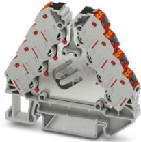
Distributeurs de potentiel, tension nominale: 250 V, intensité nominale: 17,5 A, type de raccordement: Raccordement Push-in, 1., 2., 3. und 4. Etage, Section de référence: 1,5 mm<sup>2</sup>, section : 0,14 mm<sup>2</sup> - 2,5 mm<sup>2</sup>, montage: NS 35/7,5, NS 35/15, coloris: gris, couleur des éléments de raccordement: rouge
