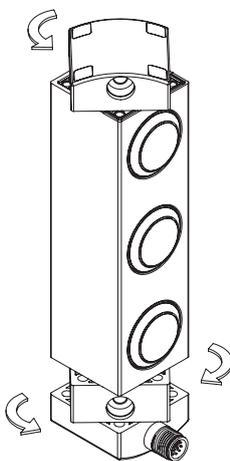
Lors de l'installation, les modules de fixation supérieur et inférieur sont réglables, de sorte que le sens de fixation de l'appareil peut être facilement changé.
