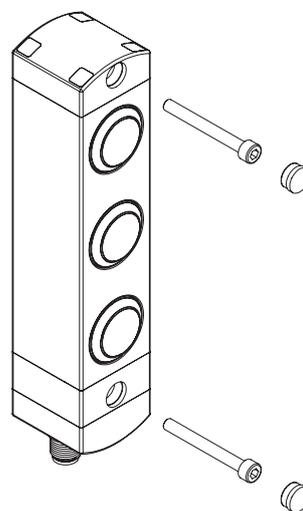
Chaque boîtier de commande de la série BN est fourni avec des capuchons de protection à clipser dans les trous des vis de fixation. Ces capuchons préviennent l'accumulation de sédiments, facilitent le nettoyage et interdisent l'accès aux vis de fixation du dispositif, ce qui permet d'offrir une plus grande garantie contre la manipulation.
