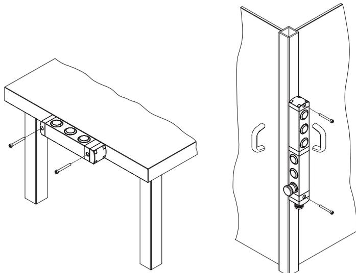
Grâce à leur structure composée de modules rotatifs, les boîtiers de commande de la série BN offrent à l'utilisateur un large éventail de possibilités de fixation à la machine.
