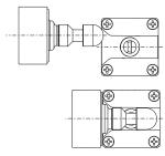
L'interrupteur est équipé d'une large entrée de centrage pour le goujon de l'actionneur. Cette solution facilite l'alignement entre l'actionneur et le trou présent dans la tête au cours de la phase de montage. De plus, elle réduit considérablement la probabilité de collision entre l'actionneur et l'interrupteur, ce qui permet son installation même sur des portes à fermeture imprécise.
