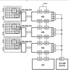
Fonction de surveillance de l'actionneur verrouillé 2 canaux / catégorie 4 / jusqu'à SIL 3 / PL e
