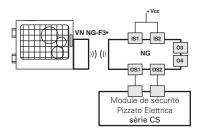
L'interrupteur de la série NG peut être utilisé individuellement après avoir évalué les sorties de sécurité par un module de sécurité de Pizzato Elettrica (voir le tableau des modules de sécurité compatibles).
