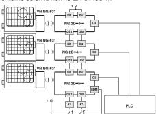
Cette version dispose d'entrées de sécurité IS et, tout en maintenant le niveau de sécurité maximal PL e spécifié dans la norme EN 13849-1 et SIL 3 spécifié dans la norme EN 62061, elle peut être ajoutée à la fin d'une série de jusqu'à 32 interrupteurs NG.
