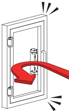
L'interrupteur NS est doté d'une fonction spécifique qui empêche le protecteur de se verrouiller après une fermeture violente ou trop rapide provoquant son rebondissement et sa réouverture. Cette fonction évite l'ancrage immédiat du protecteur même si la commande de verrouillage est activée et elle protège l'interrupteur du contre-coup typique qui caractérise les interrupteurs à verrouillage instantané, en évitant d'endommager le dispositif.
