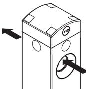
L'interrupteur présente un trou traversant pour l'insertion de l'actionneur. C'est grâce à cette particularité que la poussière qui pourrait éventuellement pénétrer dans l'orifice de l'actionneur a toujours la possibilité de sortir du côté opposé, au lieu de rester à l'intérieur. En outre, le goujon de verrouillage est équipé d'un joint à membrane externe qui permet de l'utiliser dans des endroits poussiéreux.
