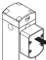
**2100 N** Le système d'interverrouillage résistant garantit une force de retenue maximale de l'actionneur  $F_{1max}$  égale à 2100 N.
