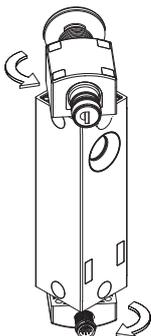
Le module supérieur de l'interrupteur, intégrant les dispositifs de déverrouillage, et le module inférieur comprenant les sorties de connexion, sont orientables et ne sont pas détachables : en agissant sur les vis de fixation, il est possible de tourner les modules de 90° à la fois, d'où la possibilité d'obtenir d'autres configurations avec le même article, sans que l'installateur ait besoin de se soucier de la manière d'assembler les différentes pièces.
