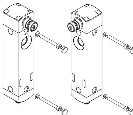
sans opérations supplémentaires telles que la rotation du module où se trouve l'entrée de l'actionneur. Les trous de fixation peuvent alors être fermés avec les capuchons de protection spéciaux fournis, afin d'éviter toute accumulation possible de sédiments ou toute tentative d'effraction.
