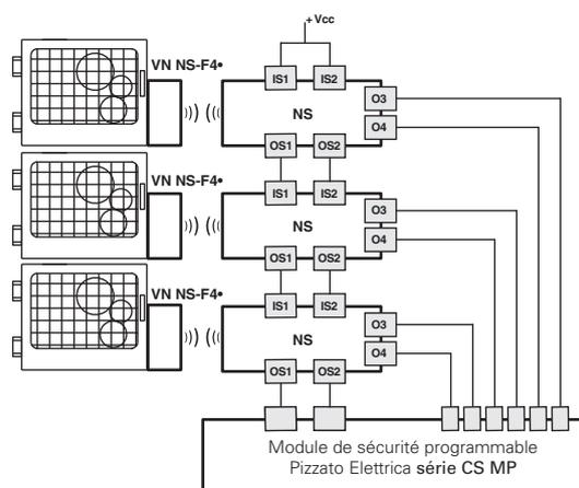
Possibilité de connexion en série de plusieurs interrupteurs pour simplifier le câblage du système de sécurité avec l'évaluation préalable des sorties du dernier interrupteur de la chaîne par un module de sécurité Pizzato Elettrica de la série CS MP qui permet de gérer soit la partie de sécurité soit celle de signalisation.
