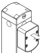
Chaque interrupteur comporte à l'intérieur un mécanisme permettant de maintenir l'actionneur en position fermée. Cela s'avère idéal pour toutes les applications impliquant le déverrouillage simultané de plusieurs protecteurs, mais l'ouverture effective d'un seul. Le mécanisme maintient en place tous les protecteurs déverrouillés avec une force d'environ 20 N, évitant ainsi que des vibrations ou des rafales de vent ne puissent les ouvrir.
