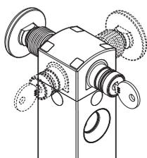
Le déverrouillage à serrure (auxiliary release) ne permet le déblocage de l'actionneur que par un personnel en possession de la clé d'actionnement. Le mécanisme fonctionne également en absence d'alimentation électrique et, une fois actionné, empêche le blocage de la protection.
