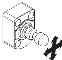
Tous les actionneurs de la série NS sont de type articulé et permettent au goujon de s'adapter au trou de centrage présent dans l'interrupteur. Aucune opération précise d'alignement actionneur-interrupteur n'est donc nécessaire pendant l'installation. De plus, grâce à sa flexibilité, l'actionneur peut être utilisé sur des protecteurs à rayon minimum d'actionnement de 150 mm, sans avoir à incliner le goujon au préalable.
