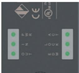
Conçu pour un diagnostic rapide et simple, l'état de chaque entrée et sortie est signalé par une LED. De cette façon, vous pouvez rapidement localiser les points d'interruption de la chaîne sécurisée, quel dispositif est déverrouillé, quel protecteur est ouvert et les erreurs à l'intérieur du dispositif. Le tout d'une façon immédiate, sans avoir à décoder des séquences complexes de clignotement.
