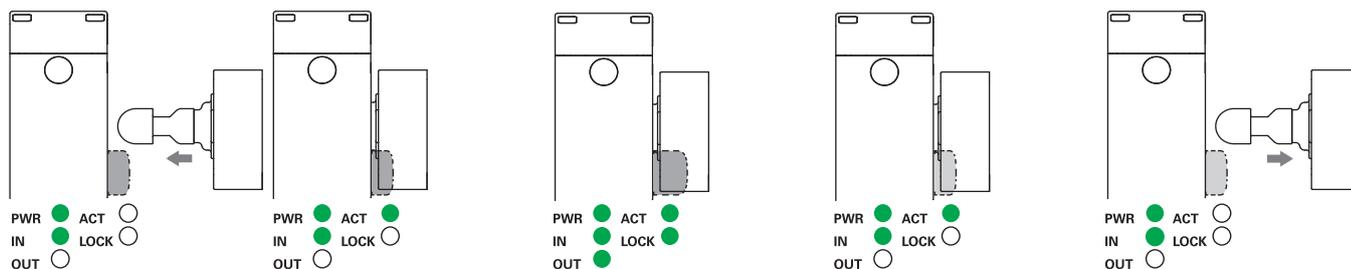
L'interrupteur est alimenté (LED PWR allumée en vert), les entrées IS1, IS2 sont activées (LED IN allumée en vert), les sorties de sécurité OS1, OS2 sont désactivées (LED OUT éteinte). L'actionneur est à l'extérieur de la zone d'actionnement (LED ACT éteinte).
