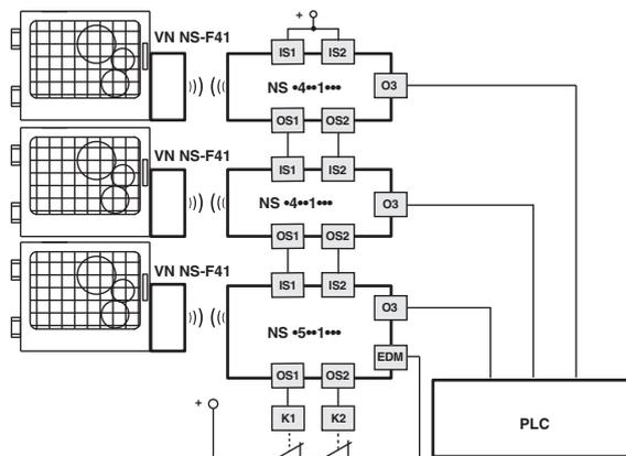
Cette version dispose d'entrées de sécurité IS et, tout en maintenant le niveau de sécurité maximal PL e spécifié dans la norme EN 13849-1 et SIL 3 spécifié dans la norme EN 62061, elle **peut être ajoutée** à la fin d'une série de jusqu'à 32 interrupteurs NS.
