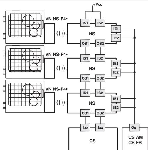
Fonction de surveillance de l'actionneur verrouillé
