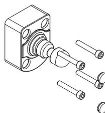
Chaque actionneur de la série NS est fourni avec quatre capuchons de protection à clipser. Ces capuchons préviennent l'accumulation de sédiments, facilitent le nettoyage et interdisent l'accès aux vis de fixation de l'actionneur. Il est donc possible d'utiliser des vis standard à la place des vis anti-effraction.
