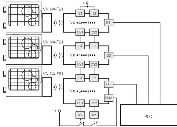
Cette version dispose d'entrées de sécurité IS et, tout en maintenant le niveau de sécurité maximal PL e spécifié dans la norme EN 13849-1 et SIL 3 spécifié dans la norme EN IEC 62061, elle **peut être ajoutée à la fin d'une série de jusqu'à 32 interrupteurs NX**. Cette solution permet d'éviter l'utilisation d'un module de sécurité qui serait sinon connecté au dernier dispositif de la série. Lorsque la fonction EDM est présente, elle doit être utilisée.
