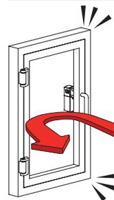
L'interrupteur NX est doté d'une fonction spécifique qui empêche le protecteur de se verrouiller après une fermeture violente ou trop rapide provoquant son rebondissement et sa réouverture. Cette fonction évite l'ancrage immédiat du protecteur même si la commande de verrouillage est activée et elle protège l'interrupteur du contre coup typique qui caractérise les interrupteurs à verrouillage instantané, en évitant d'endommager le dispositif.
