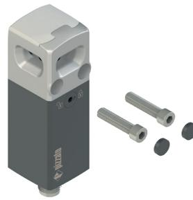
La fixation de l'interrupteur se fait directement sur la tête en métal au moyen de deux vis M5 avec un entraxe de 20 mm. Le positionnement des points de fixation à proximité du point de traction de l'actionneur permet de répartir les forces sur une structure en métal robuste et compacte. Cela garantit que l'interrupteur, en dépit de ses dimensions compactes, peut supporter des contraintes mécaniques importantes sans être endommagé ni
