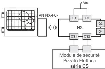
L'interrupteur de la série NX peut être utilisé individuellement après avoir évalué les sorties de sécurité par un module de sécurité de Pizzato Elettrica (voir le tableau des modules de sécurité compatibles).
