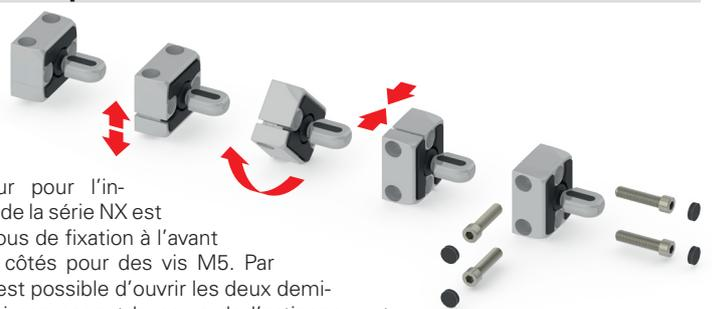
L'actionneur pour l'interrupteur de la série NX est doté de trous de fixation à l'avant et sur les côtés pour des vis M5. Par ailleurs, il est possible d'ouvrir les deux demi-coques qui composent le corps de l'actionneur et de tourner le plan de travail de l'actionneur de 90°.
