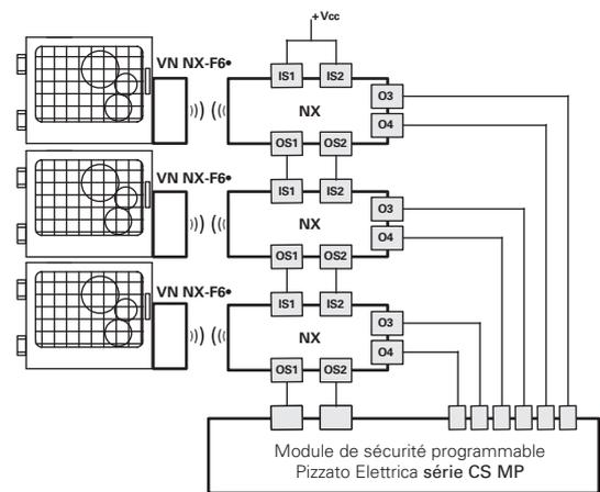
Possibilité de connexion en série de plusieurs interrupteurs pour simplifier le câblage du système de sécurité avec l'évaluation préalable des sorties du dernier interrupteur de la chaîne par un module de sécurité Pizzato Elettrica de la série CS MP qui permet de gérer soit la partie de sécurité soit celle de signalisation.
