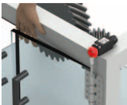
Contrôle du point d'intervention selon EN ISO 13857 ; si nécessaire, recalibrer le point d'intervention.
