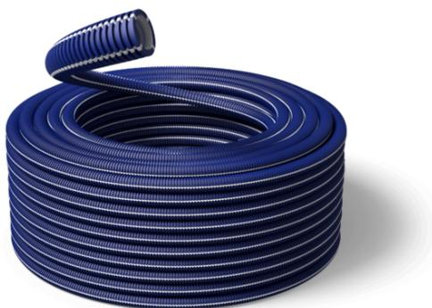
FLEX LUB PLUS EVO est la nouvelle gaine à double peau avec un glissage très élevé : la paroi intérieure en composé polymère réduit la friction par rapport à une gaine standard en polypropylène. Elle est également transversalement élastique et garantie sans micro-trous, adaptée pour un emploi dans le béton et le ciment. Facilement reconnaissable avec sa couleur bleue, sa ligne blanche et sa paroi intérieure blanche. Écologique : Halogen Free (sans halogène) selon la norme NF EN 50642.
