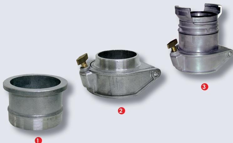
Le raccord mâle équipe la sortie des bouches d'incendie. Le raccord femelle, avec étrier et vis de verrouillage, équipe les pièces de jonction qui se branchent sur ces bouches d'incendie.
