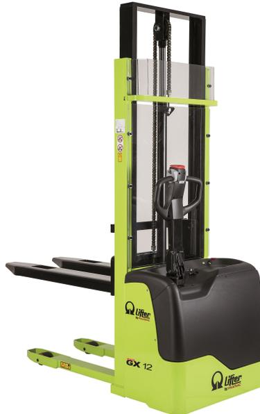
Ce gerbeur de taille compacte, puissant et fiable, est la solution idéale pour travailler dans des espaces étroits. La largeur réduite (800 mm), le système de conduite latérale et son large mât lui assure une grande maniabilité, stabilité et visibilité. La batterie et le chargeur (câble extensible + prise) intégrés font de la série GX le gerbeur prêt à l'emploi.
