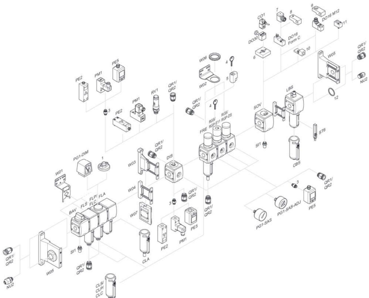
1 = Indicateur d'encrassement 3 = Double manchon 4 = Clé pour fermeture E11 5 = Serrure à encastrer 6 = Plaque d'adaptation DO30 7 = Adaptateur, Série CON-VP 8 = Aide au montage DO16, Forme C 9 = Aide au montage DO16, M12 10 = Adaptateur air de pilotage externe 11 = Adaptateur Commande pneumatique 12 = Bague d'étanchéité
