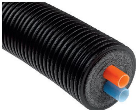
Système de canalisation pré-isolée, très flexible, comportant deux tubes caloporteurs (aller et retour) dans la même gaine extérieure, principalement utilisé pour le transport de l'eau de chauffage, de l'eau chaude sanitaire ou d'autres fluides dans des réseaux enterrés.
