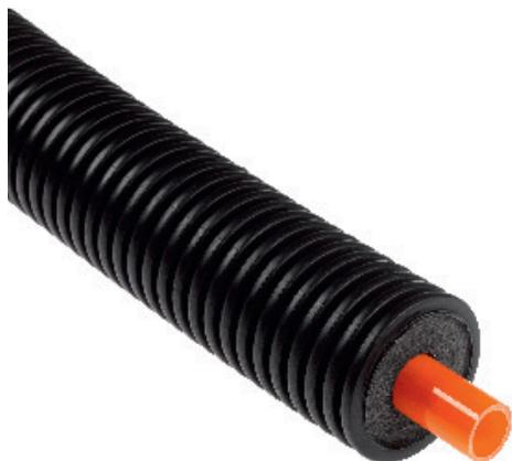
Système de canalisation pré-isolée, très flexible, avec tube caloporteur simple, principalement utilisé pour le transport de l'eau de chauffage, de l'eau chaude sanitaire ou d'autres fluides dans des réseaux enterrés.
