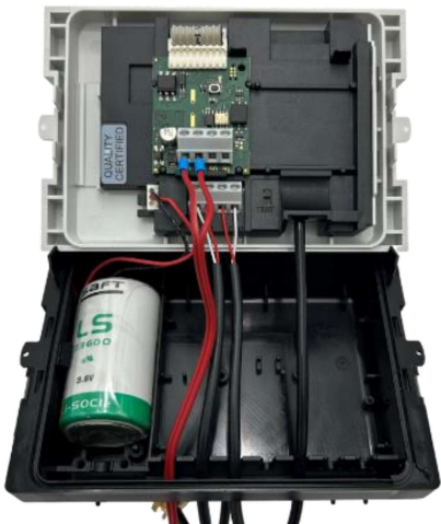
Figure 5 Exemple de câblage de l'alimentation
