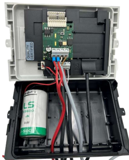
Figure 7 Exemple de module correctement câblé
