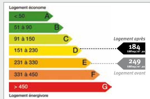
(3) Maison avec murs en parpaings creux, non isolés, sur terre-plein et sur sous-sol, sous combles perdus, isolant laine de verre 15 cm, avec simple vitrage bois et sans volets. Résultats obtenus sur la base de situations effectuées par une société de diagnostic énergétique indépendante au 01/02/2011.
