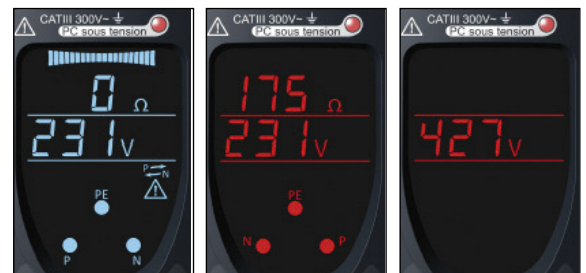
Prise mal câblée: phase présente sur PE
