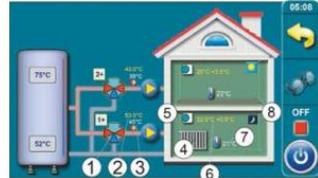
Il est possible de contrôler graphiquement le fonctionnement des deux circuits de chauffage pilotés par l'unité CM2K à l'aide de l'écran ci-dessus sur la chaudière SX Easy.
