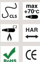
**NF C 32-201-5** : conducteurs et câbles isolés au polychlorure de vinyle, de tension assignée au plus égale à 450 / 750V. CENELEC HD 21.4.S2 et IEC 60228.
