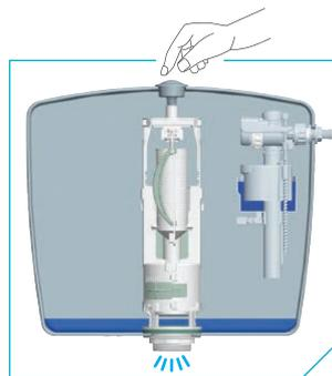
Le réservoir se vide plus rapidement que le boîtier retardateur, tandis que le robinet flotteur est toujours fermé.
