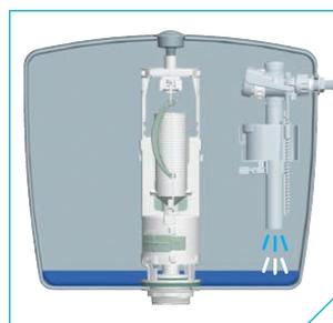
Une fois le volume d'eau libéré, le mécanisme de chasse se referme, le boîtier retardateur continue à se vider grâce au principe des vases communicants et le robinet flotteur s'ouvre pour remplir le réservoir.
