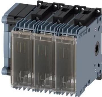
interrupteur-sectionneur à fusibles 32 A, taille 1, 3 pôles pour fusible à couteaux NH, taille 000 et 00 commande en face avant à gauche appareil de base sans manette borne à cage sans fusible
