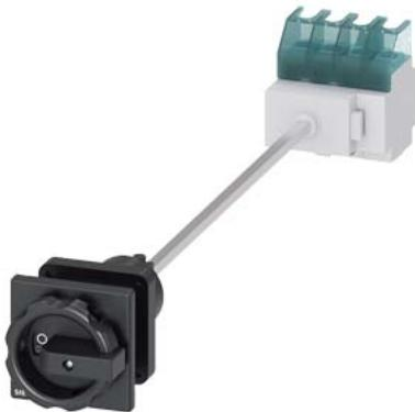
SENTRON, interrupteur-sectionneur 3LD, interrupteur général, 4 pôles, Iu : 25A, puissance d'emploi / avec AC-23 A pour 400V : 9,5 kW, Fixation au sol avec commande de porte, commande rotative, noir, Fixation centrale 22,5mm de l'organe de commande
