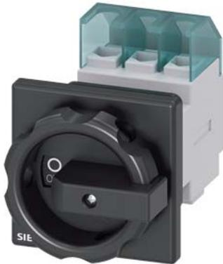
SENTRON, interrupteur-sectionneur 3LD, interrupteur général, 3 pôles, Iu : 25A, puissance d'emploi / avec AC-23 A pour 400V : 9,5 kW, fixé à l'avant, commande rotative, noir, Fixation centrale 22,5mm de l'organe de commande
