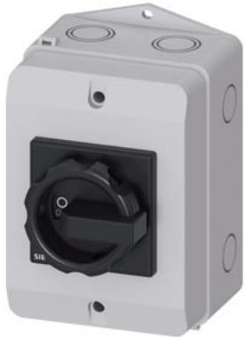
SENTRON, interrupteur-sectionneur 3LD, interrupteur général, 3 pôles, lu : 25A, puissance d'emploi / avec AC-23 A pour 400V : 9,5 kW, coffret en matière isolante pour presse-étoupe métrique, 1 NF, 1S, commande rotative, noir
