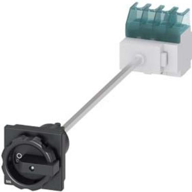
SENTRON, interrupteur-sectionneur 3LD, interrupteur général, 4 pôles, Iu : 32 A, puissance d'emploi / avec AC-23 A pour 400V : 11,5 kW, Fixation au sol avec commande de porte, commande rotative, noir, Fixation par 4 trous de l'organe de commande
