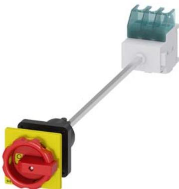
SENTRON, interrupteur-sectionneur 3LD, interrupteur de coupure d'urgence, 3-pôles, Iu : 32 A, Puissance de service / avec AC-23 A pour 400V : 11,5 kW, Fixation au sol avec commande de porte, commande rotative, rouge/jaune, Fixation centrale 22,5mm de l'organe de commande
