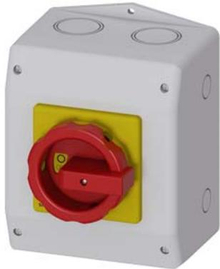
SENTRON, interrupteur-sectionneur 3LD, interrupteur de coupure d'urgence, 6 pôles, Iu : 32 A, Puissance de service / avec AC-23 A pour 400V : 11,5 kW, coffret en matière isolante pour presse-étoupe métrique, commande rotative, rouge/jaune
