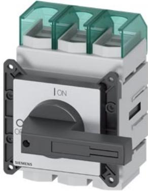
SENTRON, interrupteur-sectionneur 3LD, interrupteur général, 3 pôles, lu : 160 A, puissance d'emploi / avec AC-23 A pour 400V : 75 kW, fixé à l'avant, commande par manette, noir, Fixation par 4 trous de l'organe de commande
