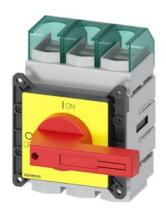
SENTRON, interrupteur-sectionneur 3LD, interrupteur de coupure d'urgence, 3-pôles, lu : 160 A, Puissance de service / avec AC-23 A pour 400V : 75 kW, fixé à l'avant, commande par manette, rouge/jaune, Fixation par 4 trous de l'organe de commande
