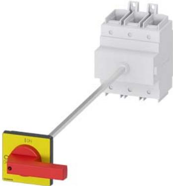
SENTRON, interrupteur-sectionneur 3LD, interrupteur de coupure d'urgence, 3-pôles, I<sub>u</sub> : 160 A, Puissance de service / avec AC-23 A pour 400V : 75 kW, Fixation au sol avec commande de porte, commande par manette, rouge/jaune, Fixation par 4 trous de l'organe de commande
