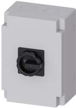
SENTRON, interrupteur-sectionneur 3LD, interrupteur général, 6 pôles, Iu: 63A, puissance d'emploi / avec AC-23 A pour 400V : 22 kW, coffret en matière isolante pour presse-étoupe métrique, 1 NF, 1S, commande rotative, noir
