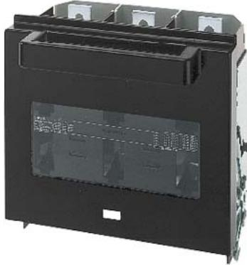
SENTRON, fusible-interrupteur-sectionneur 3NP5, 3 pôles, NH3, 630 A, pour Montage et encastrement sur plaque de montage, avec Enclement brusque, borne à vis, interrupteur auxiliaire sur l'interrupteur-sectionneur : 1 contact à fermeture+1 contact à ouverture,
