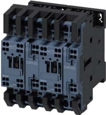
contacteur-inverseur, AC-3e/AC-3, 12 A, 5,5 kW / 400 V, 3 pôles, 24 V CA, 50/60 Hz, borne à ressort, verrouillage électrique et mécanique, contacts auxiliaires : 2 x 1 NO
