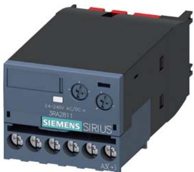
relais temporisé électronique, temporisé à l'appel, avec sortie à semiconducteur, plage de temps 0,05-100 s, 24-240 V CA / CC 50/60 Hz, varistance intégrée pour l'amortissement des bobines de contacteur, borne à vis, encliquetable en face avant sur contacteurs 3RT201 / 3RT202 et contacteurs auxiliaires 3RH2
