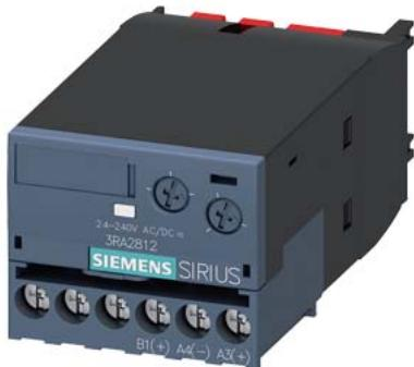
relais temporisé électronique, retardé à la retombée, avec signal de commande et sortie à semiconducteur, plage de temps 0,05-100 s, 24-240 V CA / CC 50/60 Hz, varistance intégrée pour l'amortissement des bobines de contacteur, borne à vis, encliquetable en face avant sur contacteurs 3RT201 / 3RT202 et contacteurs auxiliaires 3RH2
