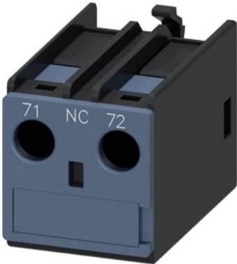
bloc de contacts auxiliaires, en face avant, 1 NF, 71/72, circuit : 1 NF, entrée de câbles par le haut, borne à vis, pour contacteurs 3RT2 et contacteurs auxiliaires 3RH2
