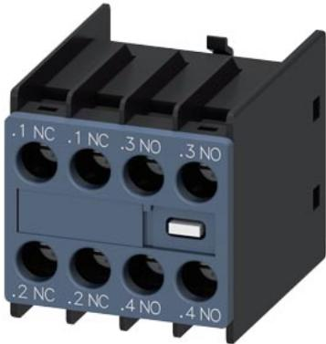
bloc de contacts auxiliaires, en face avant, 2 NO + 2 NF, .1/.2, .1/.2, .3/.4, .3/.4, circuit : 1 NF, 1 NF, 1 NO, 1 NO, borne à vis, pour contacteurs 3RT2 et contacteurs auxiliaires 3RH2
