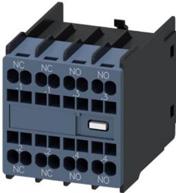
bloc de contacts auxiliaires, en face avant, 2 NO + 2 NF, .1/.2, .1/.2, .3/.4, .3/.4, circuit : 1 NF, 1 NF, 1 NO, 1 NO, borne à ressort, pour contacteurs 3RT2 et contacteurs auxiliaires 3RH2
