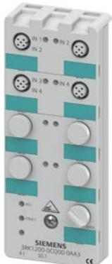
Module compact K60 AS-i numérique 4 entrées TOR, IP67 4 x entrées, 200 mA max. 4 x connecteurs femelle M12 avec brochage Y-II Plaque de montage 3RK1901-0CA00 à commander séparément
