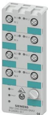
Module compact K60 AS-i numérique 8 entrées TOR, IP67 8 x entrées, 200 mA max. 8 x connecteurs femelle M12 avec brochage Y-II Plaque de montage 3RK1901-0CA00 à commander séparément
